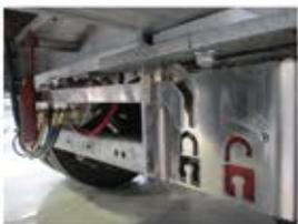
Dispositif de verrouillage coulissant avec bras allongé
