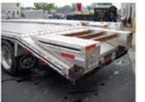
Arrière plat horizontal avec rampe pliable et planches de palette
