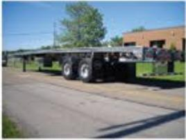
Remorque à essieu coulissant conforme à la réglementation de l'Etat de Californie
