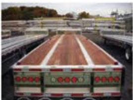
Plateforme en keruing en option avec verrous de conteneurs
